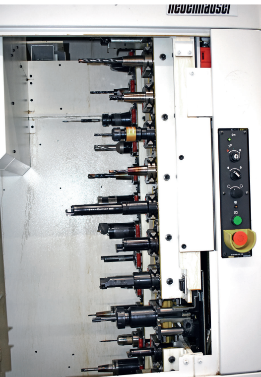
6 Blick ins Werkzeugmagazin der Multus U4000: Platz für 80 Capto-C6-Werkzeuge
