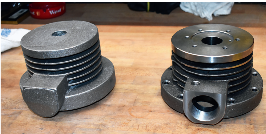
3 Roh- und Fertigteil eines auf der Multus komplett bearbeiteten Zylinders für den Neuenhauser Kompressorbau (© Hommel)
